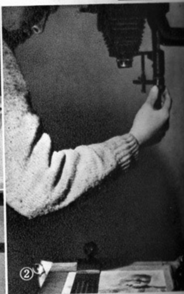
② ネガ狭みを引伸機に入れて点灯し、拡大率をきめてからピントを合わせる
